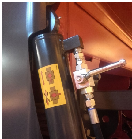
Kuva 32. Nostosylinterin turvaventtiili suljettuna.
