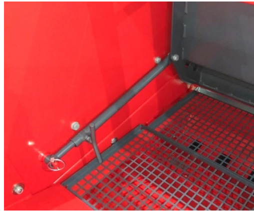
Kuva 8. Säiliön väliseinän säätötanko.
