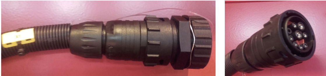
Kuva 6. Työkoneen ISOBUS -liitin.
