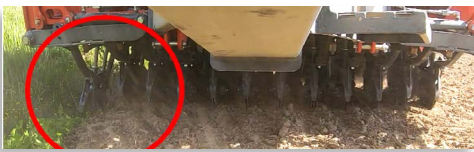
Imagen 2. El punto fuerte de las rejas Orion es su geometría y su excepcional amplitud de movimiento, tanto hacia arriba como hacia abajo. Esto permite sembrar con éxito incluso después de un tratamiento de siembra más modesto.
