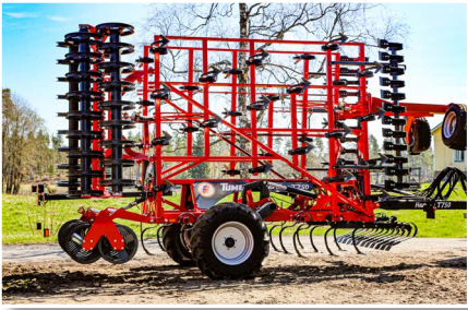
La amplia distancia entre orugas y la suspensión hidráulica de las ruedas de transporte hacen posible su estabilidad durante el transporte por carretera.
