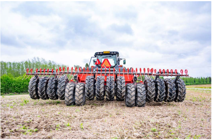
El gran juego de ruedas traseras desplazadas que sigue a la máquina no empuja la tierra delante de ella y se desplaza con suavidad. Los pares de neumáticos que circulan detrás de la máquina garantizan un transporte estable y robusto.
