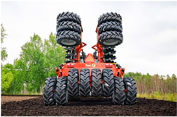
El gran juego de ruedas traseras desplazadas que sigue a la máquina no empuja la tierra delante de ella y se desplaza con suavidad. Los pares de neumáticos que circulan detrás de la máquina garantizan un transporte estable y robusto.
