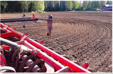
El packer doble de perfil en U estándar soporta la máquina en toda su anchura y facilita enormemente el control de la profundidad de trabajo en diferentes condiciones.
