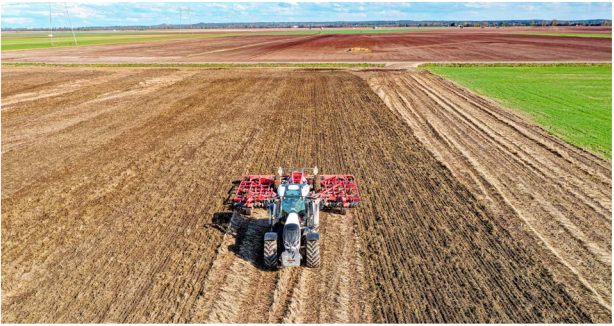
La rastra Serie T labra el suelo con rugosidad cuando es necesario y se mantiene bien abierta al cultivar incluso los rastrojos más duros.
