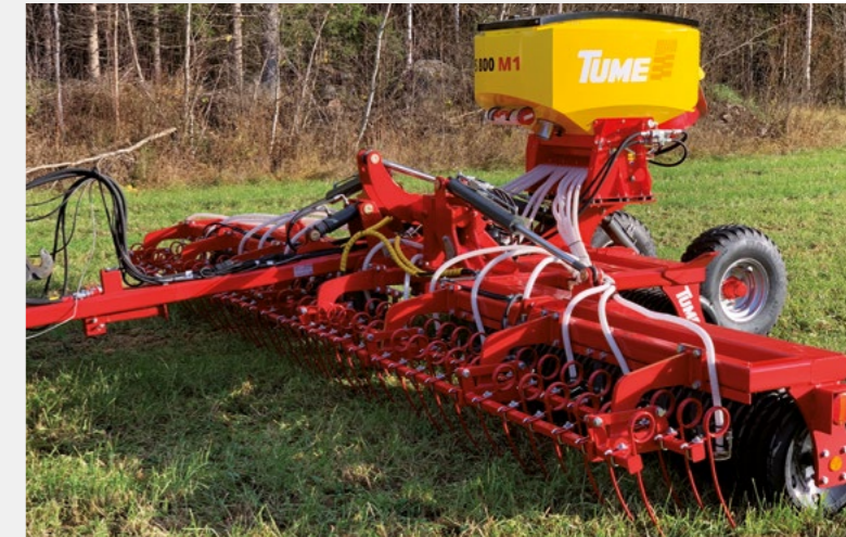
DUBBELRADIG FRAMHARV. TVÅ OLIKA TYPER AV PINNALTERNATIV.
