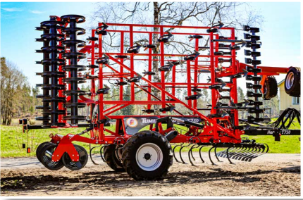
Kuljetuspyörien leveä raideväli ja hydraulinen jousitus mahdollistavat vakaan kurjetuksen maantiellä.
