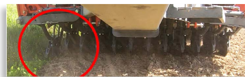
Kuva 2. Orionin vantaiston vahvuus on sen geometria ja poikkeuksellisen laaja liikerada niin ylös- kuin alaspäin. Tämä mahdollistaa onnistuneen kylvön vaatimattomamman kylvömuokkauksen jäljeltä.
